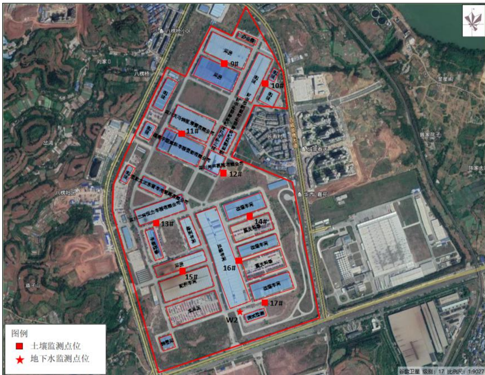
图7.1-2 本项目地块内土壤和地下水监测点位示意图（零部件产业园）
