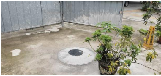
地下水监测井
